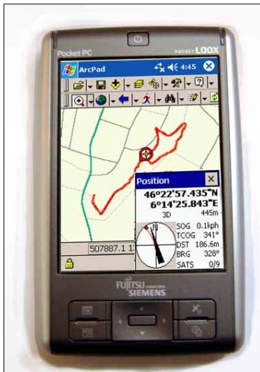
Slika 19: Sprejemnik Fujitsu-Siemens Pocket LOOX s programsko opremo ArcPad
