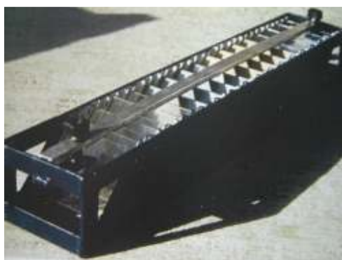
Slika 14 in 15: Vzorčevalnik s stekelci (slika 14, vir: M. Nose, 2001).
