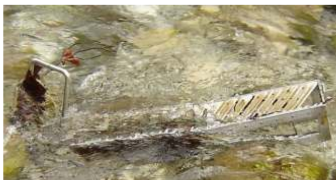
Slika 14 in 15: Vzorčevalnik s stekelci (slika 14, vir: M. Nose, 2001).
