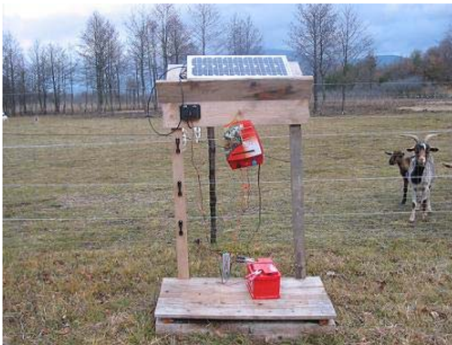
Slika 8: Električni pastir na sončne kolektorje (foto: Knap M.)
