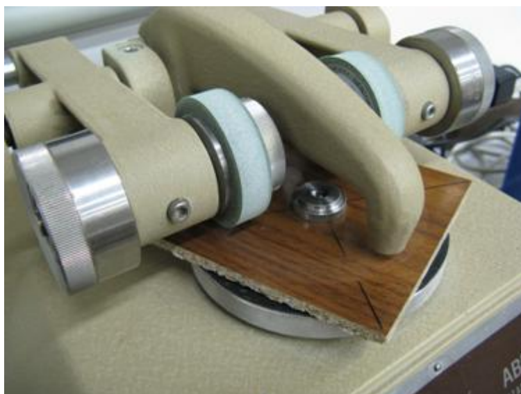
Slika 8: Obrabljanje površine vzorca z brusnima kolutoma CS-17
