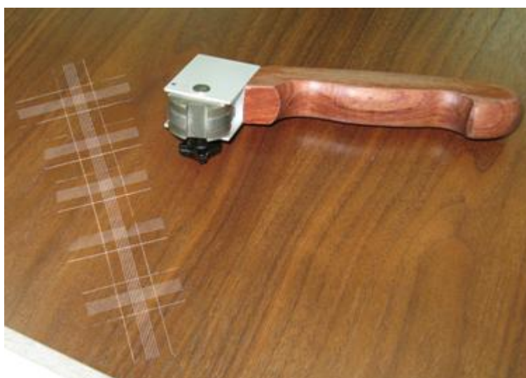
Slika 9: Nož s šestimi rezili za križno zarezovanje z razmikom 1 mm oz. 2 mm
