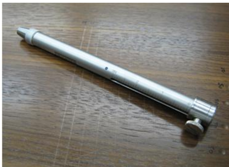
Slika 4: Vzmetni svinčnik za določanje odpornosti proti razenju
