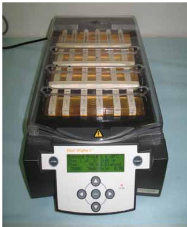
**Slika 11:** Izoelektrični fokusirni sistem s keramičnimi nosilci Ettan<sup>TM</sup> IPGphor<sup>TM</sup>.
