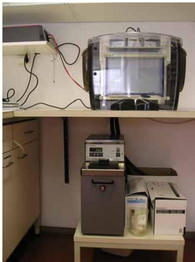
**Slika 14:** Sistem Ettan<sup>TM</sup> DALTsix s hladilnikom in usmernikom EPS 601.
