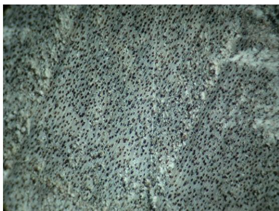
Slika 33: Prečni prerez vzorca, impregniranega s sredstvom A pri 6X povečavi
