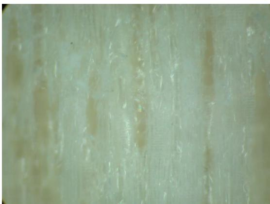
Slika 41: Radialni prerez neimpregniranega vzorca pri 30X povečavi
