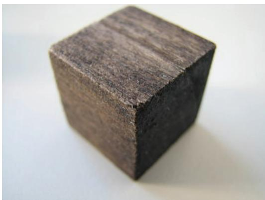
Slika 15: Očiščen vzorec po impregnaciji
