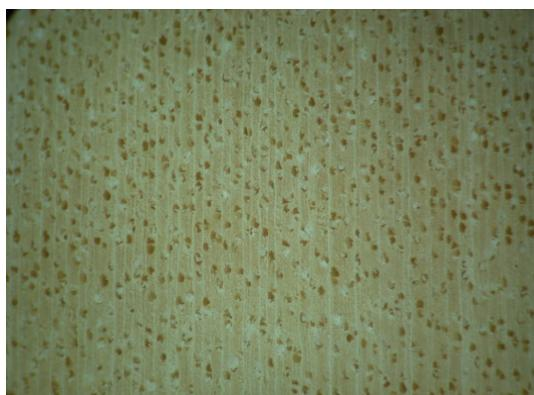
Slika 30: Prečni prerez neimpregniranega vzorca pri 12X povečavi
