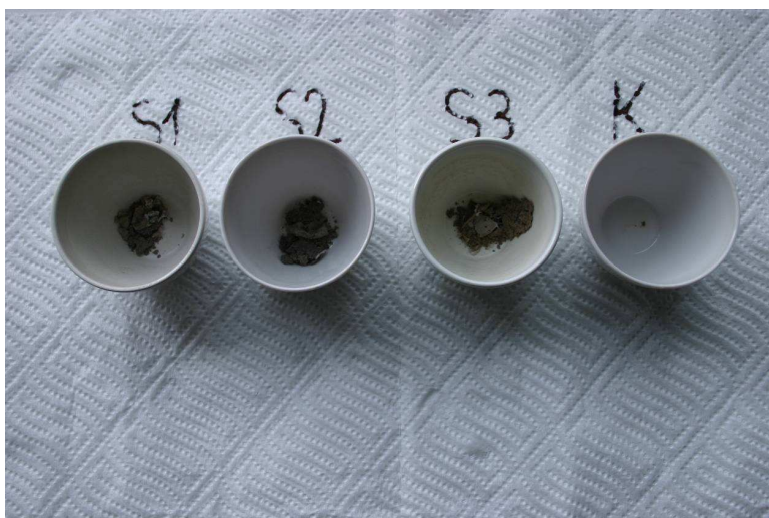
Slika 4: Keramični lončki z anorganskim ostankom perifitona in nečistoč v njem po žarjenju. Prvi trije lončki predstavljajo tri vzorčna mesta, zadnji je kontrolni, brez perifitona.
