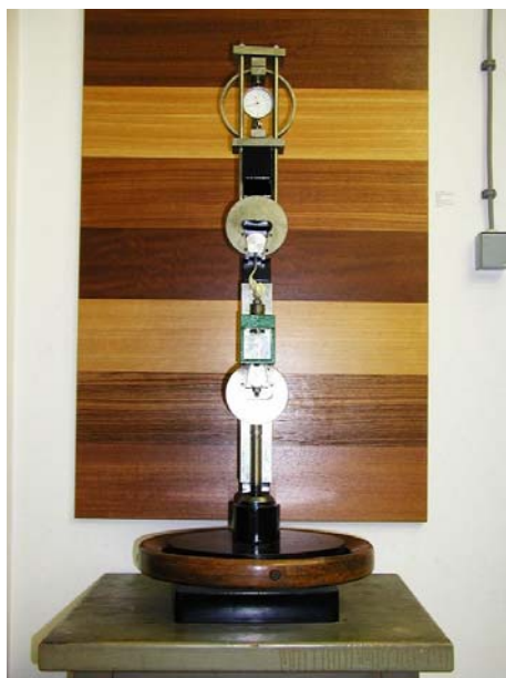
Slika 3: Instrument za merjenje natezne trdnosti, s katerim smo določali oprijemnost premazov (foto: M. Pavlič)
