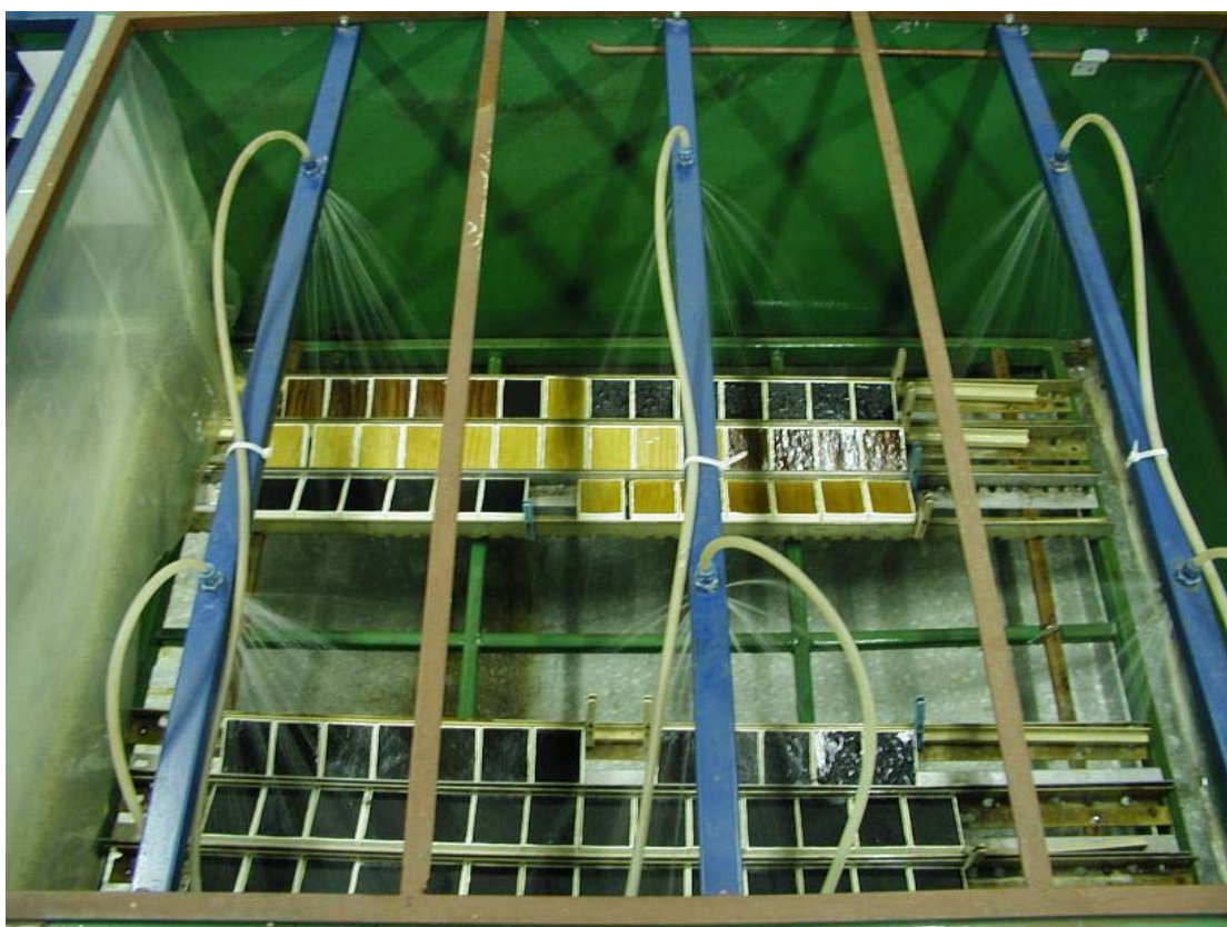
Slika 1: Umetno pospešeno staranje lesa – faza umetnega dežja (foto: M. Pavlič)
