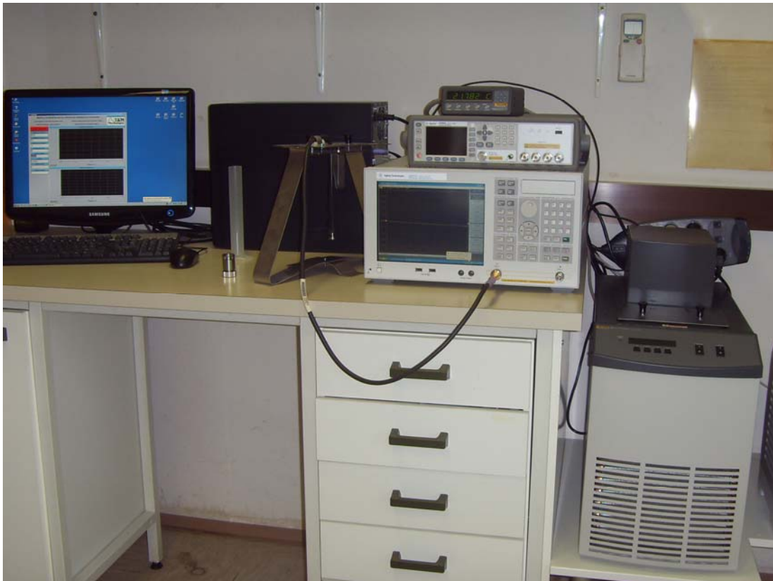
Slika 1: Fotografija sistema za merjenje dielektričnih lastnosti snovi.
