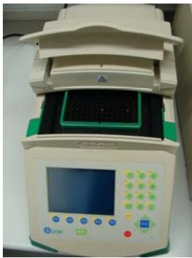
Slika 15: Naprava za PCR, BioRad
