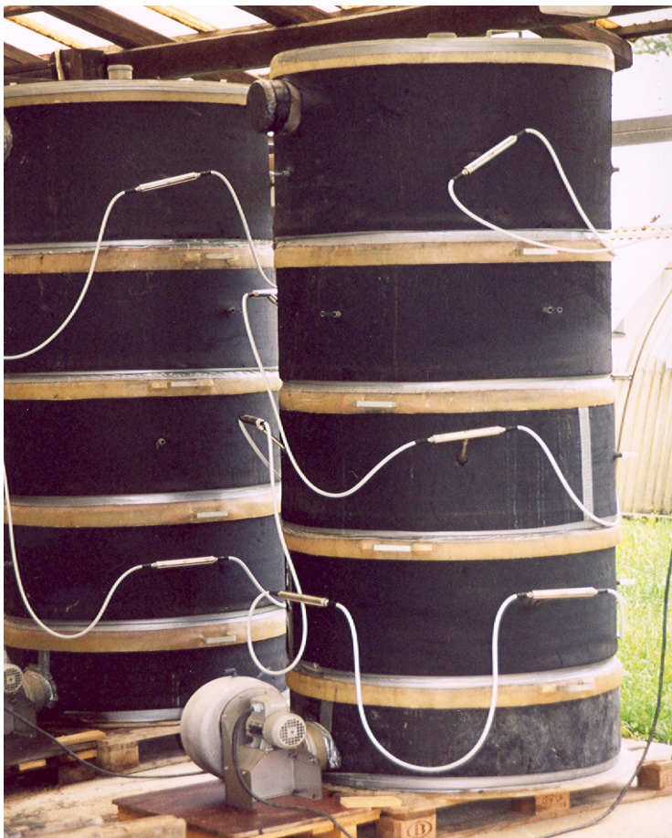
Slika 1: Kompostnik s sondami za merjenje temperature, povezane z računalnikom
