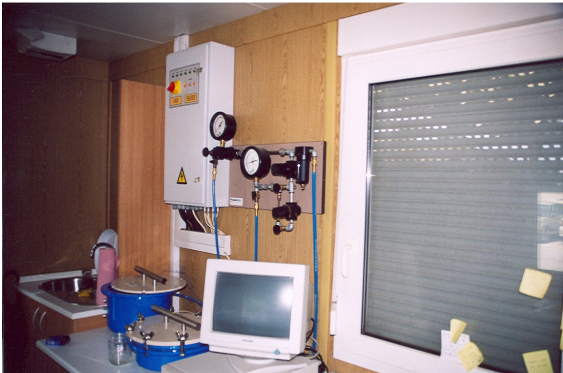
Slika 4: Računalnik, ki je vsakih 10 min vklopil hlajenje, da se kompostni kup ni pregrel
