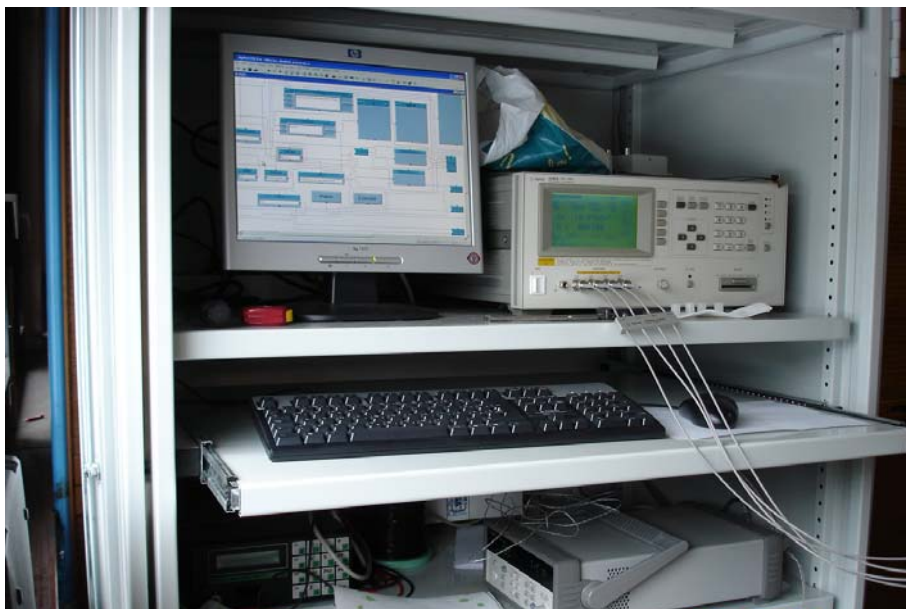
Slika 6: Povezava merilne naprave Agilent 4285A Precision LCR Meter in računalnika HP.
