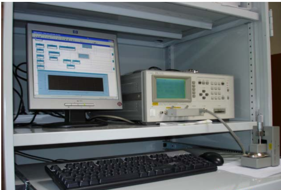
Slika 10: Povezava sonde Agilent 16451B, merilne naprave Agilent 4285A Precision LCR Meter in računalnika med meritvijo dielektričnih lastnosti furnirja.
