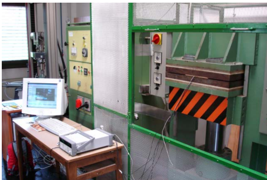
Slika 14: Merjenje porazdelitve temperature v preskušancu med klasičnim segrevanjem.
