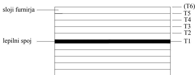
Slika 12: Shema preskušanca z označenimi mesti merjenja temperature. Na mestu T6 smo temperaturo merili le pri klasičnem segrevanju.
