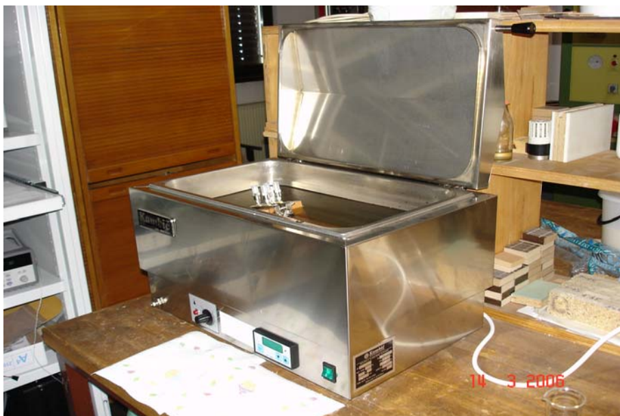
Slika 8: Vodna kopel v kateri je potopljena sonda Agilent 16452A Liquid Test Fixture.
