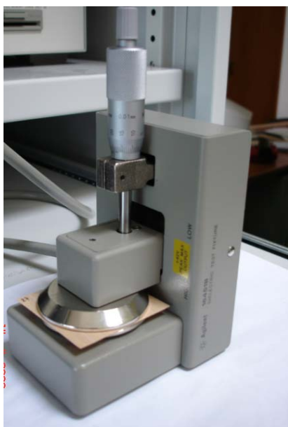
Slika 11: Sonda Agilent 16451B Dielectric Test Fixture z vstavljenim furnirjem.
