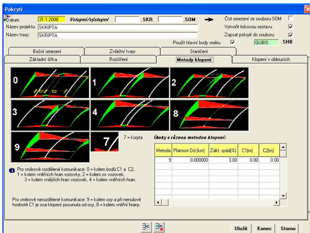
Slika 22: Vnos podatkov o prečnem naklonu vozišča
