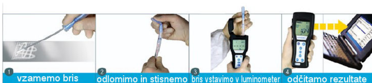
Slika 15: Prikaz poteka metode merjenja ATP-bioluminiscence (V.I.A d.o.o, 2012)
