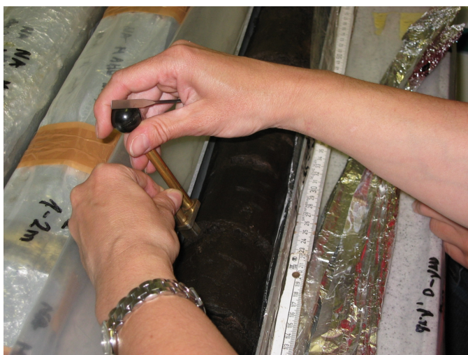
Slika 3. Del vrtine »Na mahu 1«: odvzem vzorcev s prostornino 1\text{ cm}^3 .
