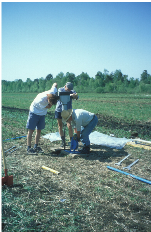
Slika 2. Vzorčno mesto »Na mahu 1«: vrtanje vrtine z Livingstonovim batnim vrtalnikom.
