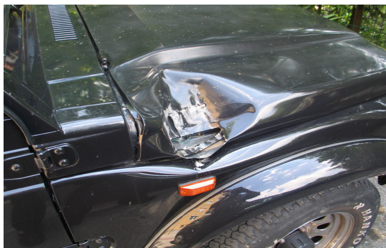
Slika 1: Primer poškodbe na vozilu zaradi padajočega kamenja (A. Paglavec, 2007)
