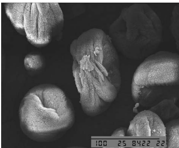
Slika 33a in 33b: Zunanja morfologija kristalov rdečega pri 500-kratni povečavi in belega vina pri 1000-kratni povečavi
