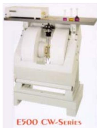
Slika 22: Spektrometer EPR za merjenje paramagnetskih molekul v magnetnem polju (EPR spektrometer Bruker BioSpin, 2005: 1)
