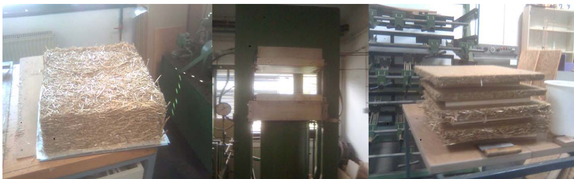
Slika 9: Priprava, stiskanje in kondicioniranje plošč
