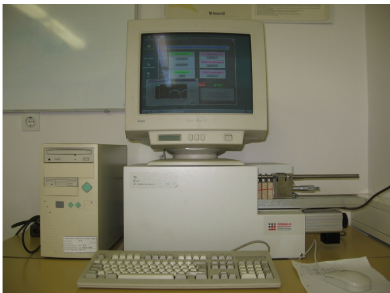
Slika 5: Merilnik gostotnih profilov MGP-201
