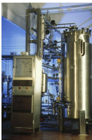
Slika 18: Bioreaktor za gojenje ogorčice Heterorhabditis bacteriophora v tekočem mediju (Improvement..., 2006)
