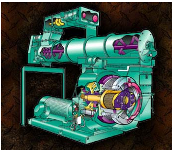
Slika 5: Stiskalnica »ring dye«. (Stiskalnica »ring dye«, 2009)
