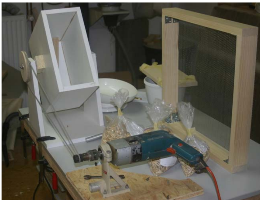
Slika 16: Poenostavljena naprava za merjenje obstojnosti peletov.
