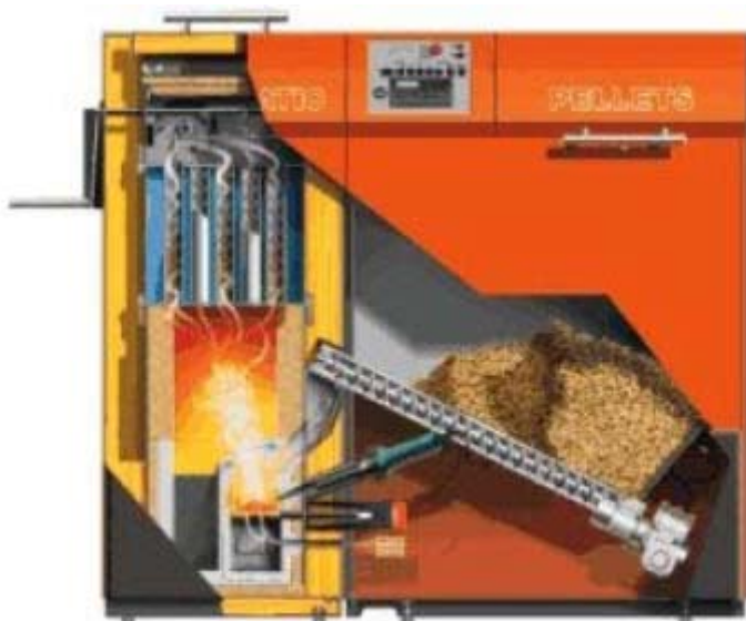
Slika 9: Prerez peči na pelete. (Pastre, 2002, str 69)
