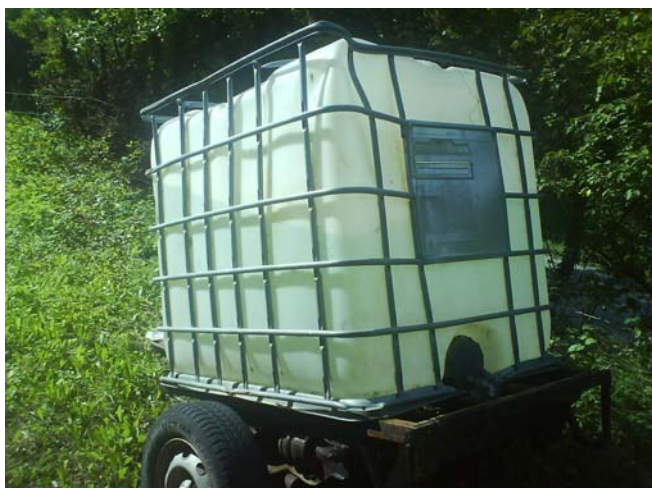
Slika 3: Cisterna za razvoz vode
