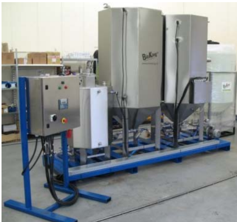
Slika 8: Bioking PRO sistem za proizvodnjo biodizla (Bioking PRO, 2008)
