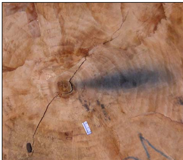
Slika 84: Rovi žužek, razpoka in siv madež
