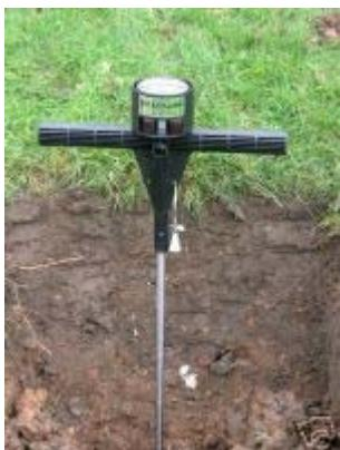
Slika 8: Ročni iglični penetrometer s številčnico Dickey John.
