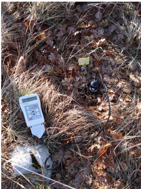
Slika 16: Prikaz sonde SM200, ki je priključena na HH2 moisture meter (Delta-T Devices ) (foto: Marinič, 2009).
