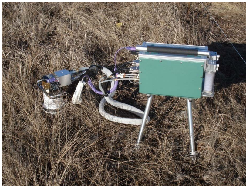
Slika 15: Prikaz meritve toka CO 2 iz tal in temperature v neposredni bližini ovratnika (foto: Marinič, 2009).
