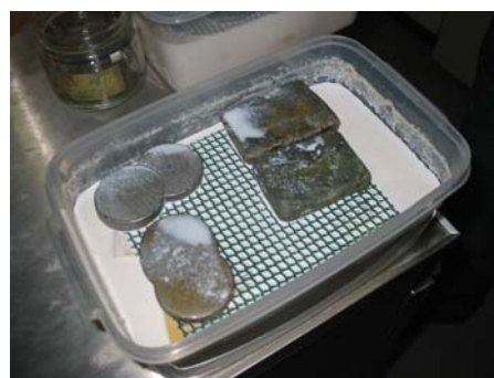
Slika 4 in 5: Obteženi in preliti vzorci s parafinsko emulzijo (levo) in tungovim oljem (desno)
