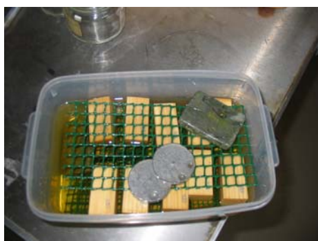
Slika 4 in 5: Obteženi in preliti vzorci s parafinsko emulzijo (levo) in tungovim oljem (desno)
