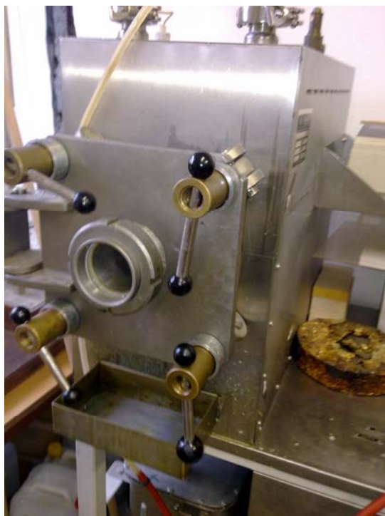
Slika 6: Vakuumsko tlačna komora za impregnacijo
