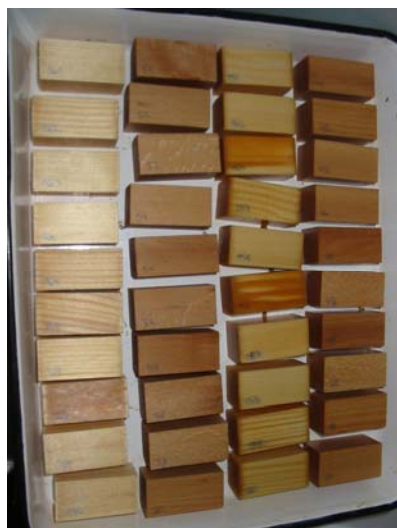
Slika 8: Vzorci, impregnirani z oljem rustikal
