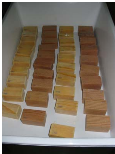
Slika 7: Vzorci, impregnirani s parafinsko emulzijo
