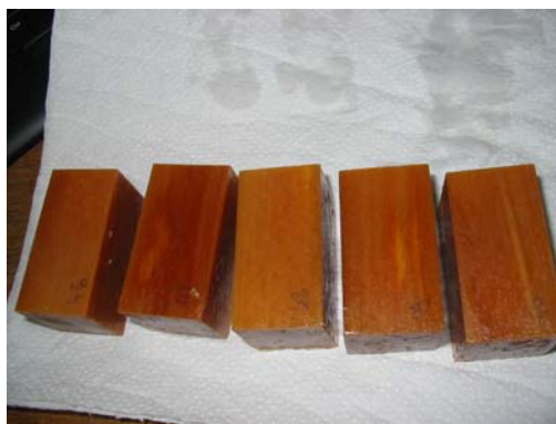
Slika 17: Vzorci vzeti iz vode med potapljanjem
