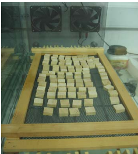
Slika 13: Prikaz steklene komore z vzorci in ventilatorji
