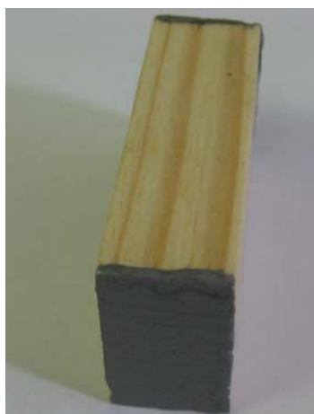
Slika 8: Prikaz vzorca zaščenega z epoksidnim premazom
