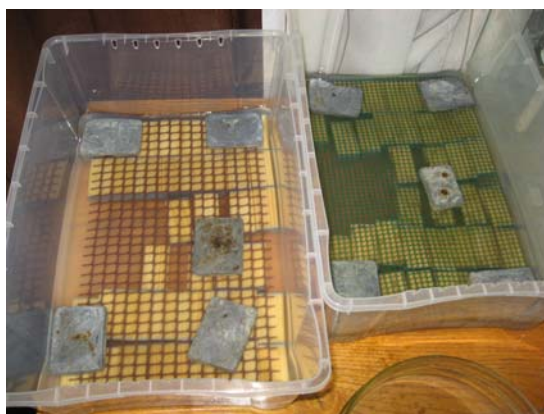
Slika 11: Vzorci v posodah preliti z destilirano vodo
