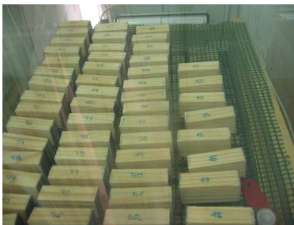
Slika 10: Vzorci, ki se navlažujejo na zraku
