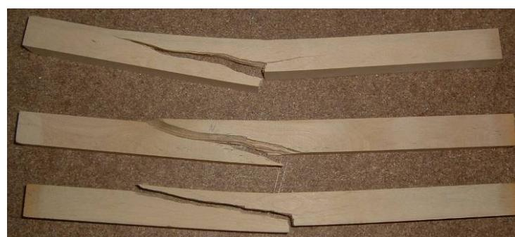
Slika 50: Porušeni vzorci upogibnega testa, opazimo odklon vlaken pri porušenih vzorcih.
