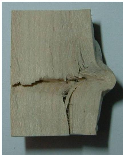
Slika 48: Porušena zgradba vzorca po tlačnem testu
