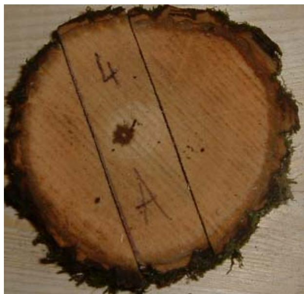
Slika 7: Izžagan vzorec za določitev radialne vlažnosti in gostote
