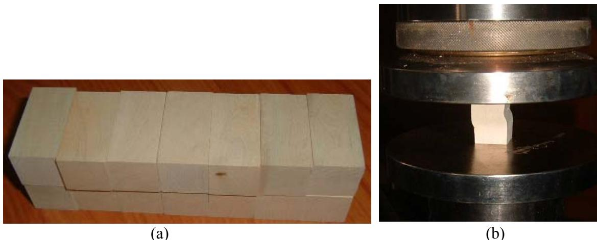
Slika 14: (a) Obdelani vzorci za preizkus tlačne trdnosti lesa; (b) stroj za preizkušanje mehanskih trdnosti ZWICK Z100, tlačni test
