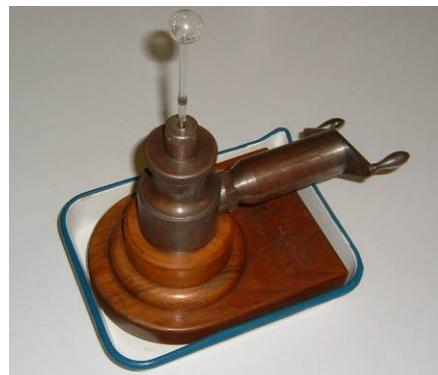
Slika 9: Naprava po BREUIL-u za merjenje volumena lesa
