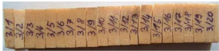
Slika 8: Radialni vzorec za določitev vlažnosti in gostote
