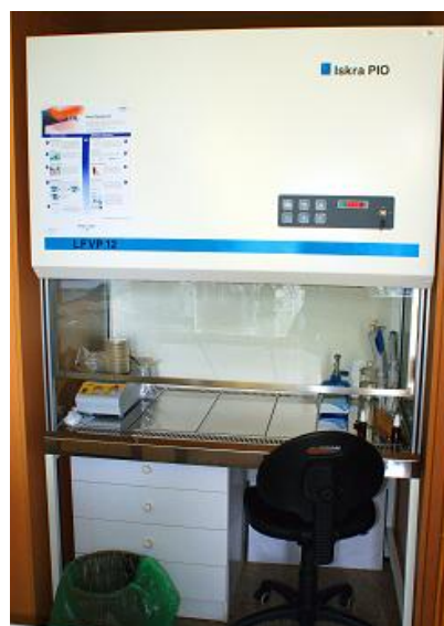
Slika 5: Brezprašna komora (D. Mesec, 2011)
