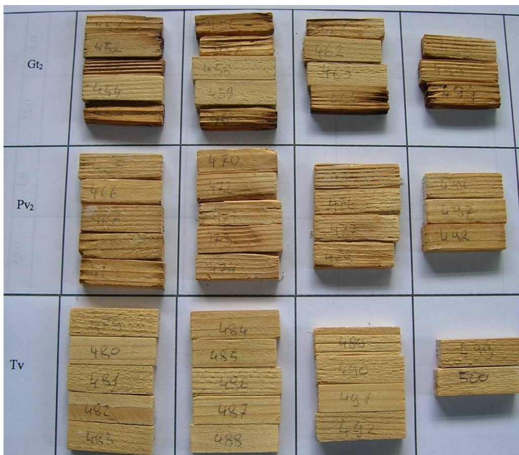
Slika 7: Primerjava kontrolnih smrekovih vzorcev po osmih tednih izpostavitve
