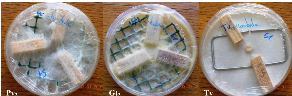
Slika 14: Kontrolni smrekovi vzorci mini blok testa po osmih tednih izpostavitve
