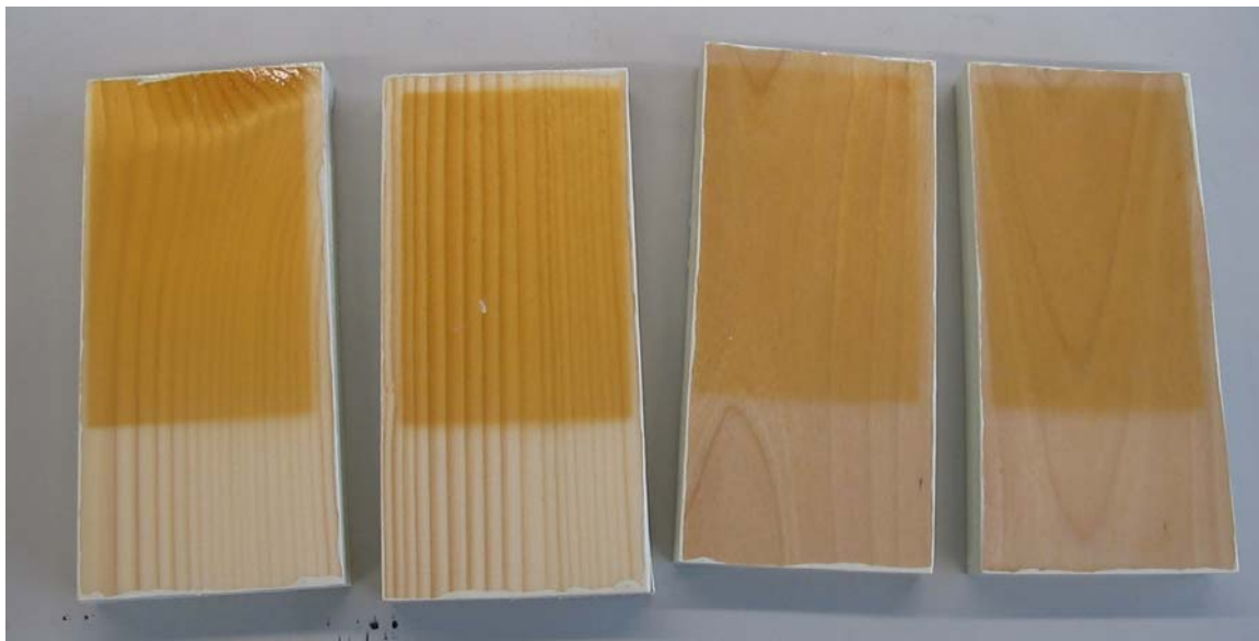
Slika 10: Barvna sprememba na svetlih lesnih vrstah (smreka – leva dva vzorca, breza – desna dva vzorca) po 68 urah izpostavitve umetnemu pospešenemu staranju.
