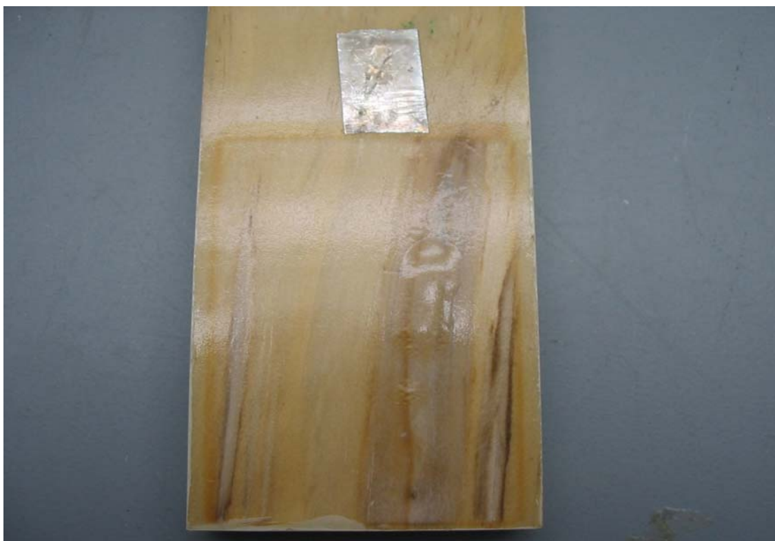
Slika 23: Mehurji in diskoloracija na vzorcu Pinus radiata .
