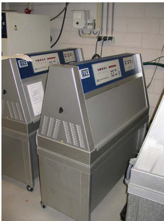
Slika 4: Naprava za simulacijo pospešenih vremenskih razmer.
