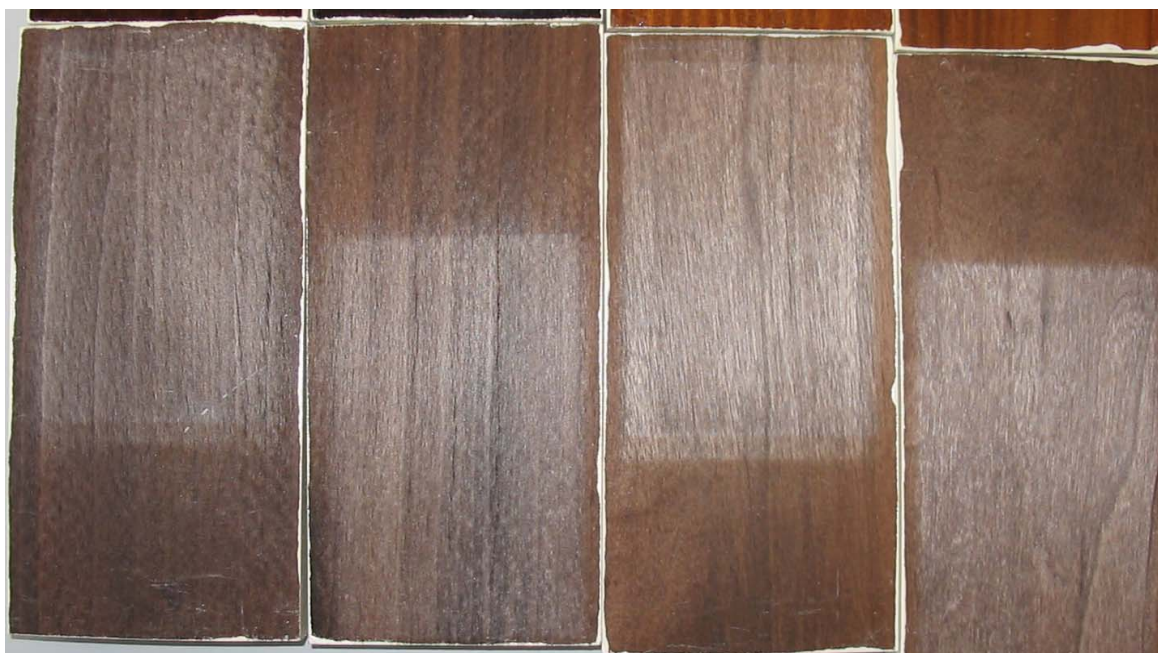
Slika 9: Sprememba barve nepremazanih vzorcev lesa Kebony po 68 urah izpostavitve umetnemu pospešenemu staranju.
