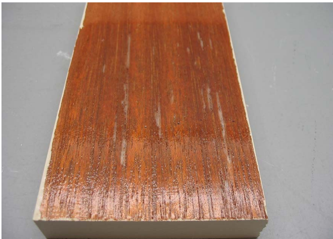
Slika 24: Pojav razpok v filmu nad velikimi porami in vzdolž rasti vlaken pri merantiju.
