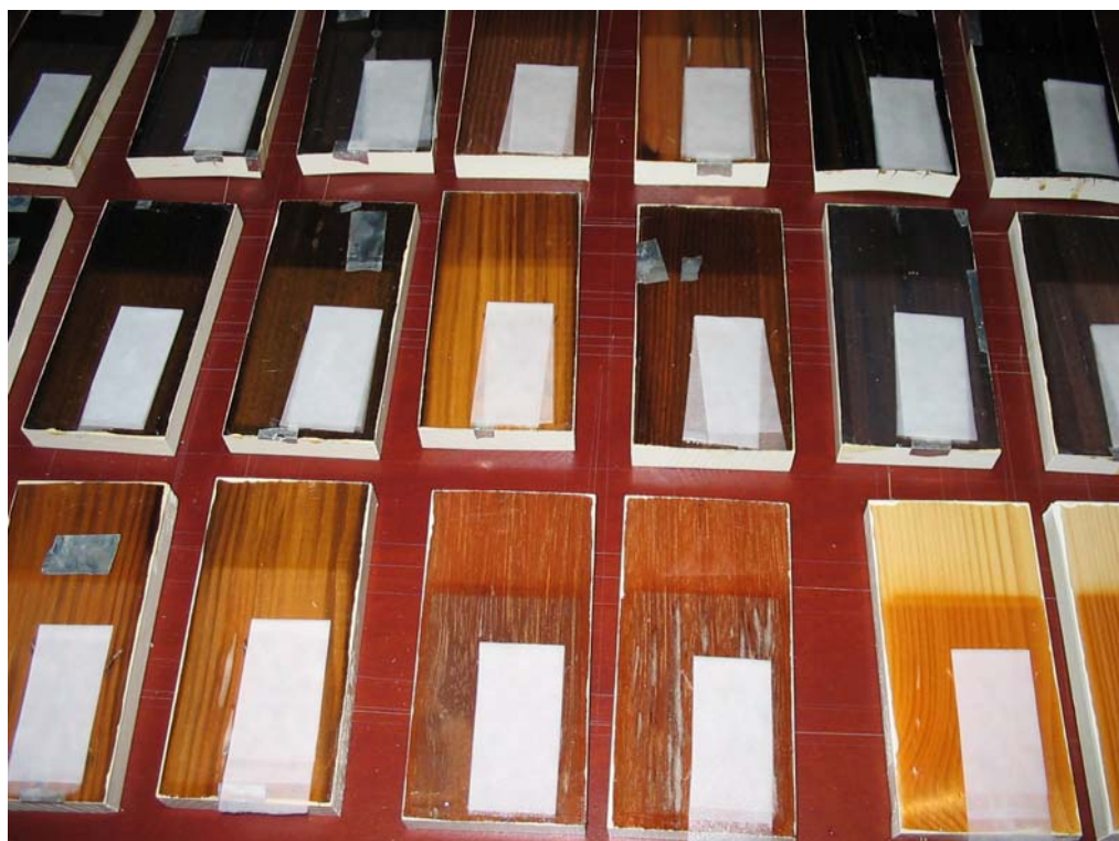
Slika 5: Križni test za določanje vlažne oprijemnosti filma.
