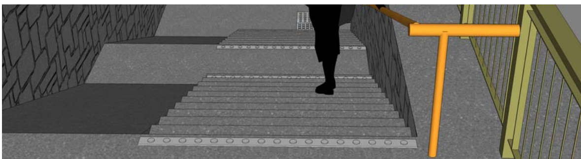
Slika 11: Opozorilna črta z izbočenimi polnimi krogi, ki opozarja na začetek oziroma konec stopnice (stopnišča).
