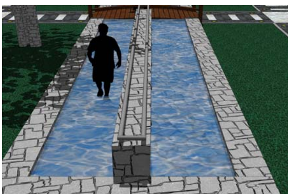
Slika 75: Različne velikosti kamenja v vodnem bazenu (levo) in ograja, vgrajena v osrednji zidec, kot vodilo za slepega (desno).
