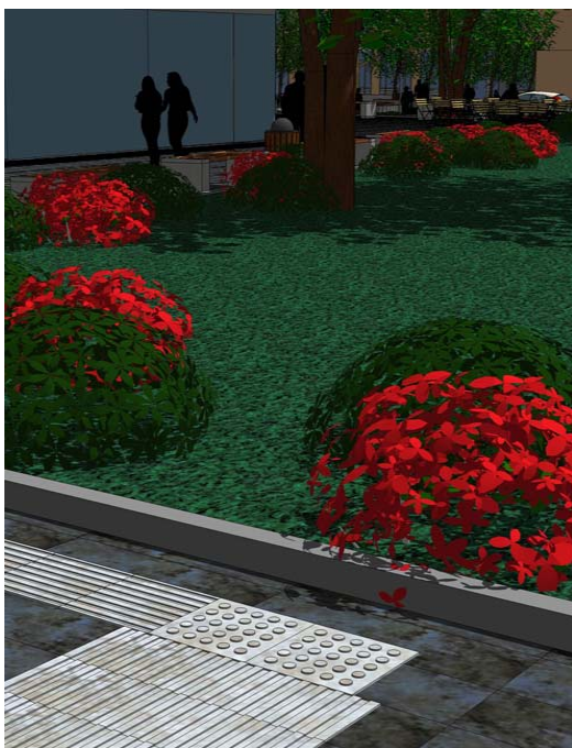
Slika 7: Primer uporabe tlakovcev tipa B, dimenzij 45 x 45 cm.
