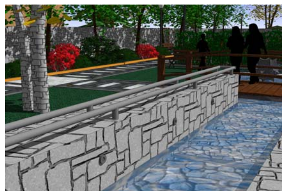
Slika 75: Različne velikosti kamenja v vodnem bazenu (levo) in ograja, vgrajena v osrednji zidec, kot vodilo za slepega (desno).
