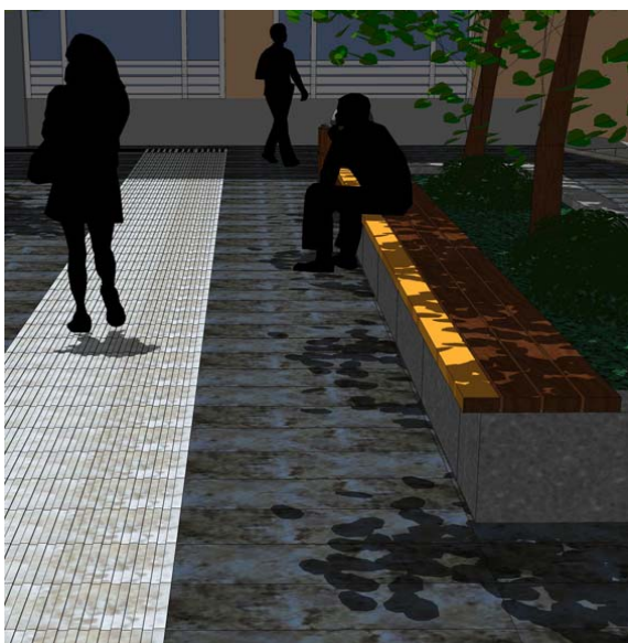
Slika 10: Barva kot opozorilo in kot sredstvo za vodenje po prostoru – levo rumeno obarvano sprednje sedišče, desno bela vodilna črta s posebno teksturo, ki slepo osebo vodi po prostoru.
