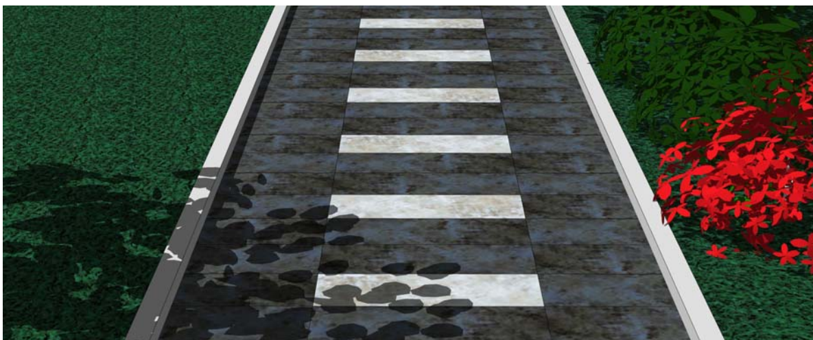
Slika 24: Način tlakovanja za vodenje slabovidne osebe po prostoru, kjer ni potrebe po taktilnih vodilnih tlakovcih.
