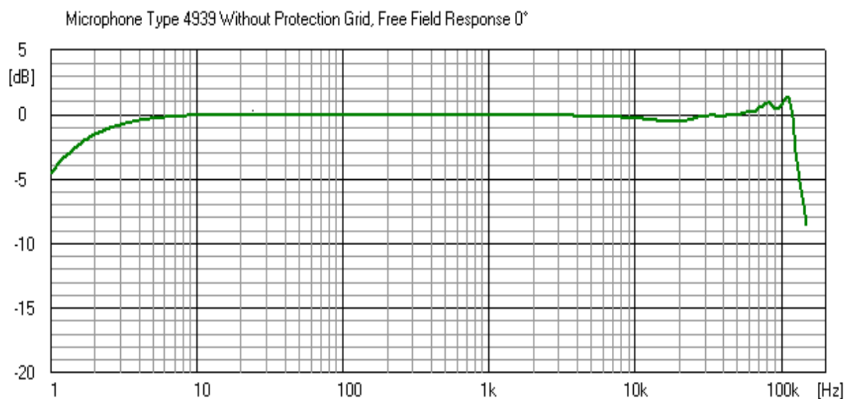
Slika 16: Prostopoljni odziv mikrofona tipa 4939 ( Brüel & Kjær )
