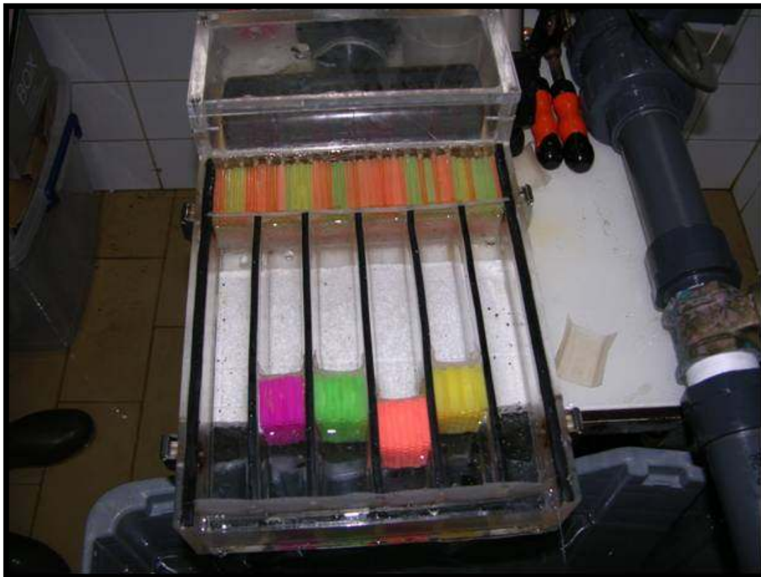
Slika 8-Plavalna komora. Prikaz smeri vodnega toka. Iz zgornje strani pritok vode v komoro in odtok na spodnji strani.
