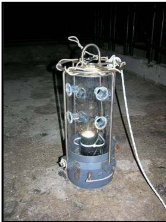
Slika 5- Lovilna past za mladice rib. Prilagojena za ulov mladice s stranskimi majhnimi odprtinami in neonsko lučjo na sredini. Ob koncu se napravo izvleče ven iz morja in mladice se zadržijo na dnu lovilne naprave.
