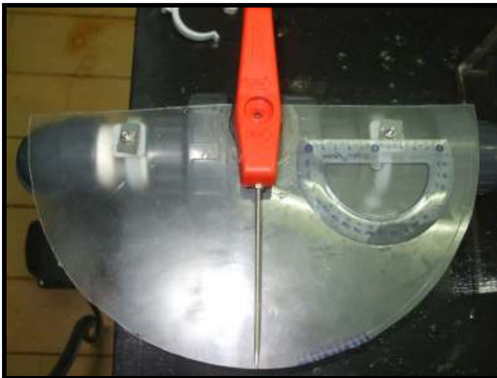
Slika 9- Prikaz posameznih umeritvenih točk določene stopnje hitrosti, glede na kot premika ročke.
