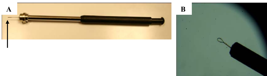
Slika 13: Zanka za lovljenje kristalov CryoLoop (Hampton Research). Oznake: A – zanka na paličici, B – v sliki A s puščico označena zanka pod stereomikroskopom.
