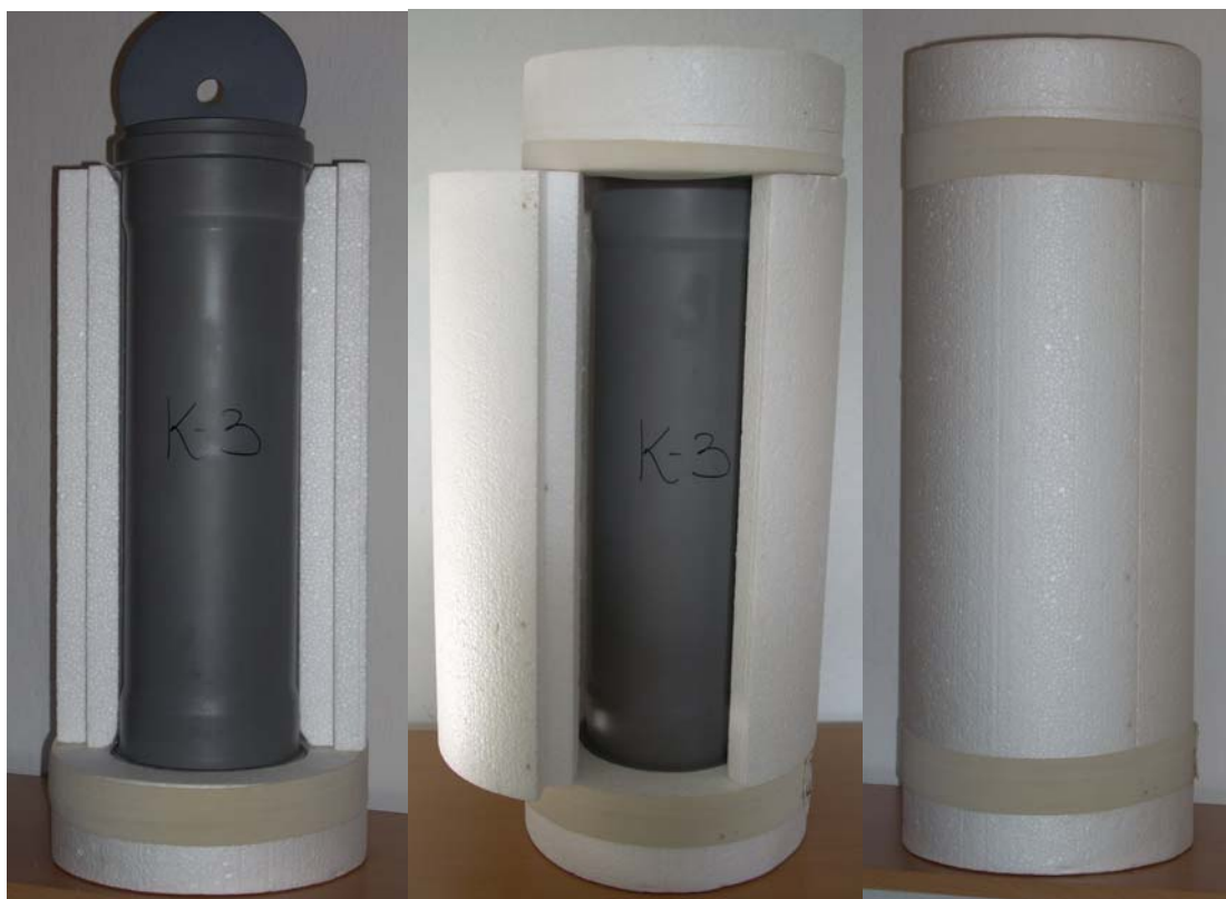
Slika 2: Izolirani laboratorijski cevni silosi za merjenje aerobne obstojnosti
