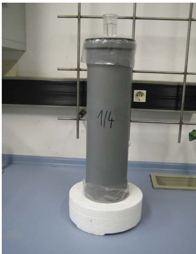
Slika 1: Laboratorijski cevni silos s podstavkom in kipelno veho
