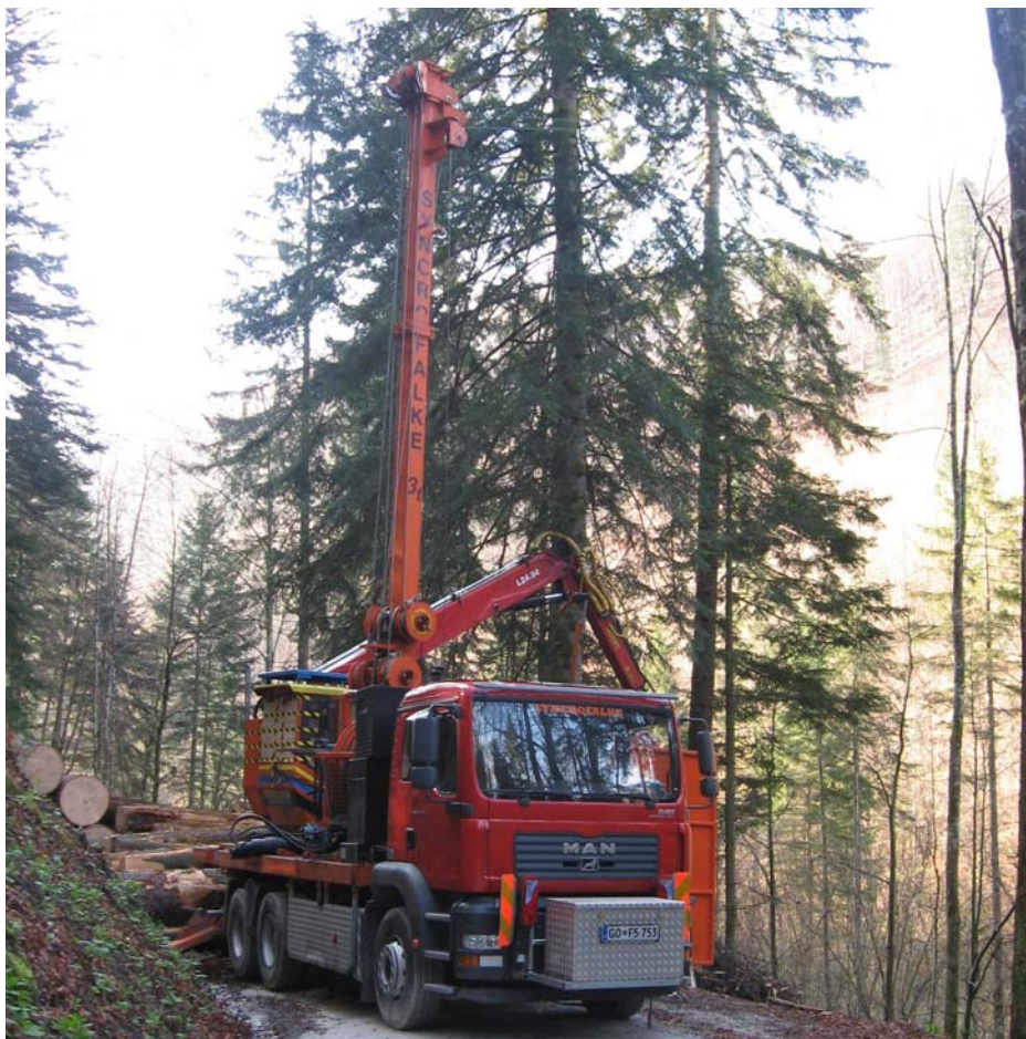
Slika 2: Žičnica Syncrofalke na kamionu MAN TGA 33. 440 6x4 BB (Foto: Opeka M., 15. 4. 2008)
