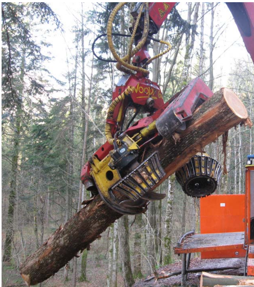
Slika 3: Procesorska glava Woody 60 na žičnici Syncrofalke (Foto: Opeka M., 15. 4. 2008)
