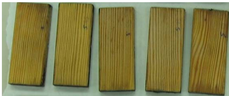
Slika 22: Pomodrele površine umetno staranih vzorcev zaščiteneh z industrijsko vodno impregnacijo Extra po izpostavitvi glivam modrivkam
