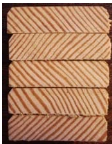
Slika 17: Neobarvan presek nestaranih vzorcev zaščitenih z vodno impregnacijo brez propikonazola po izpostavitvi glivam modrivkam
