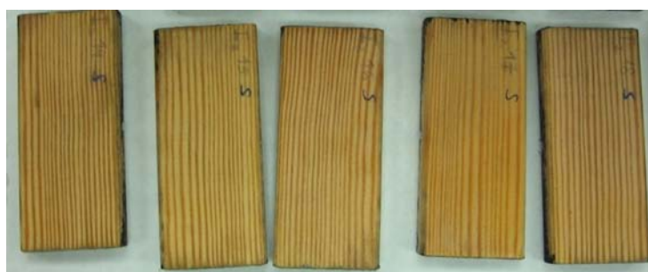
Slika 10: Nepomodrele površine umetno staranih vzorcev zaščitenih z vodno impregnacijo po izpostavitvi glivam modrivkam
