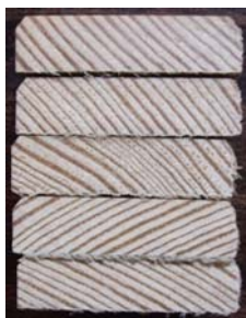
Slika 9: Neobarvan presek nestaranih vzorcev zaščitenih z vodno impregnacijo po izpostavitvi glivam modrivkam
