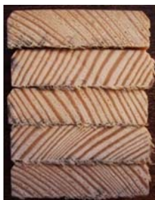
Slika 23: Obarvan presek umetno staranih vzorcev zaščiteneh z industrijsko vodno impregnacijo Extra po izpostavitvi glivam modrivkam
