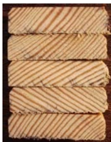
Slika 31: Obarvan presek umetno staranih vzorcev zaščitene s konkurenčno vodno impregnacijo po izpostavitvi glivam modrivkam
