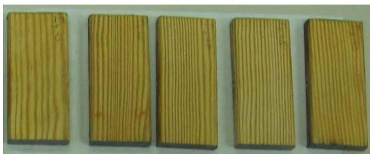
Slika 16: Minimalno oziroma nepomoderle površine nestaranih vzorcev zaščitenih z vodno impregnacijo brez propikonazola po izpostavitvi glivam modrivkam
