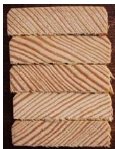
Slika 25: Neobarvan presek nestaranih vzorcev zaščitenih z industrijsko vodno impregnacijo po izpostavitvi glivam modrivkam
