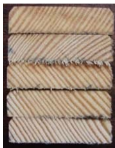
Slika 11: Minimalno obarvan presek umetno staranih vzorcev zaščitenih z vodno impregnacijo po izpostavitvi glivam modrivkam
