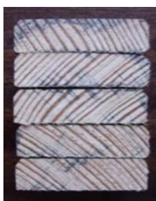
Slika 5: Obarvan presek kontrolnih vzorcev po izpostavitvi glivam modrivkam
