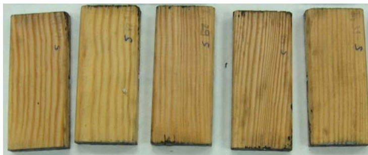
Slika 14: Pomodrele površine umetno staranih vzorcev zaščitenih z IPBC in propikonazol brez veziva po izpostavitvi glivam modrivkam
