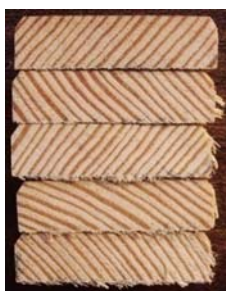
Slika 27: Obarvan presek umetno staranih vzorcev zaščitenih z Industrijsko vodno impregnacijo po izpostavitvi glivam modrivkam
