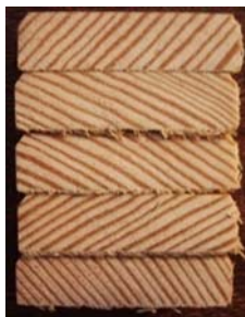
Slika 33: Neobarvan presek nestaranih vzorcev zaščitenih z razvojnim vzorcem Neocryl XK 84 po izpostavitvi glivam modrivkam
