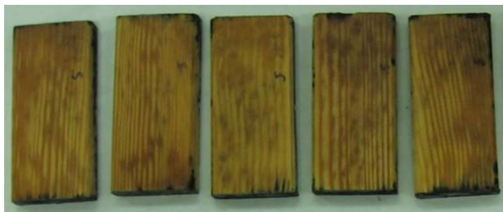
Slika 30: Pomodrele površine umetno staranih vzorcev zaščitene s konkurenčno vodno impregnacijo po izpostavitvi glivam modrivkam
