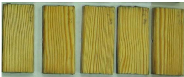
Slika 24: Minimalno oziroma nepomodrele površine nestaranih vzorcev zaščitenih z industrijsko vodno impregnacijo po izpostavitvi glivam modrivkam
