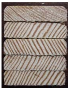
Slika 13: Neobarvan presek nestaranih vzorcev zaščitenih z IPBC in propikonazol brez veziva po izpostavitvi glivam modrivkam
