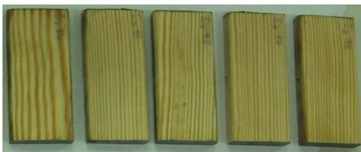
Slika 28: Minimalno oziroma nepomodrele površine nestaranih vzorcev zaščitenih s konkurenčno vodno impregnacijo po izpostavitvi glivam modrivkam
