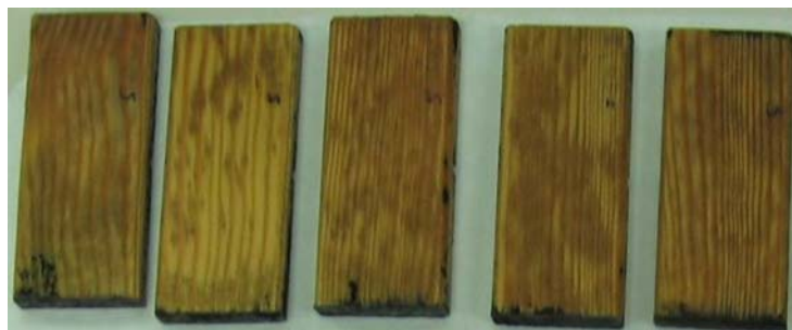
Slika 18: Pomodrele površine umetno staranih vzorcev zaščiteneh z vodno impregnacijo brez propikonazola po izpostavitvi glivam modrivkam
