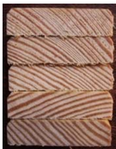
Slika 21: Neobarvan presek nestaranih vzorcev zaščiteneh z industrijsko vodno impregnacijo Extra po izpostavitvi glivam modrivkam
