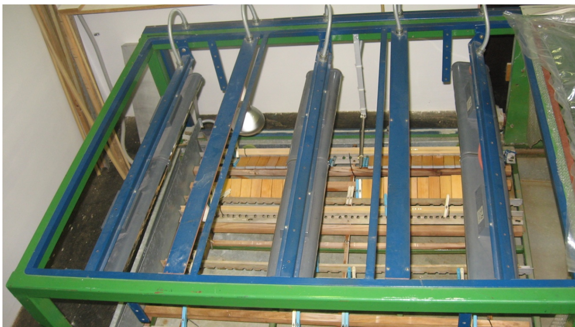
Slika 2: Umetno pospešeno staranje lesa – Del naprave, kjer se izvaja faza sevanja in mirovanja
