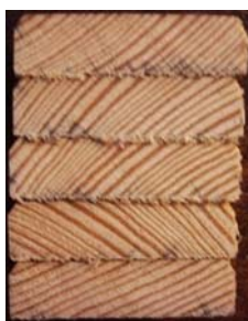
Slika 19: Obarvan presek umetno staranih vzorcev zaščiteneh z vodno impregnacijo brez propikonazola po izpostavitvi glivam modrivkam
