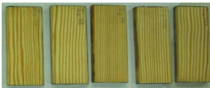
Slika 32: Nepomodrele površine nestaranih vzorcev zaščitenih z razvojnim vzorcem Neocryl XK 84 po izpostavitvi glivam modrivkam
