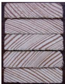
Slika 7: Neobarvan presek vzorcev zaščiteneh z raztopino boratov po izpostavitvi glivam modrivkam
