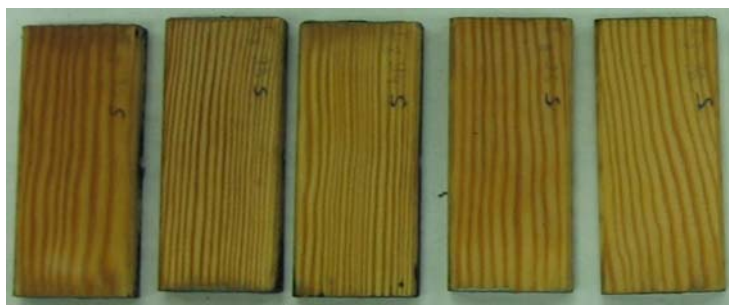
Slika 34: Minimalno oziroma nepomoderle površine umetno staranih vzorcev zaščitanih z razvojnim vzorcem Neocryl XK 84 po izpostavitvi glivam modrivkam
