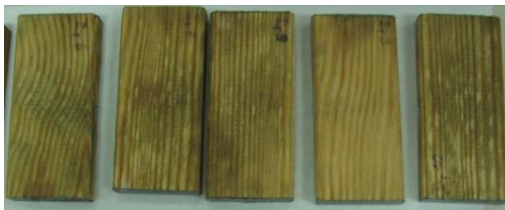
Slika 6: Pomodrele površine vzorcev zaščiteneh z raztopino boratov po izpostavitvi glivam modrivkam
