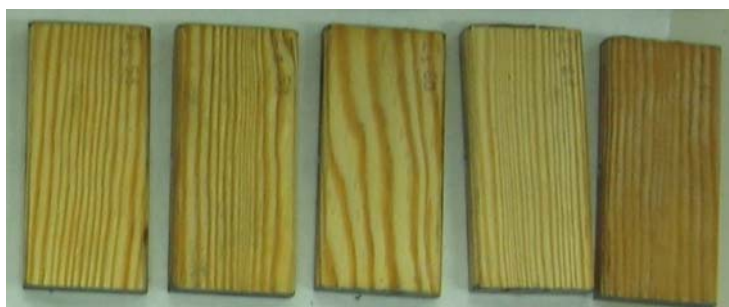
Slika 20: Minimalno pomodrele površine nestaranih vzorcev zaščitenih z industrijsko vodno impregnacijo Extra po izpostavitvi glivam modrivkam
