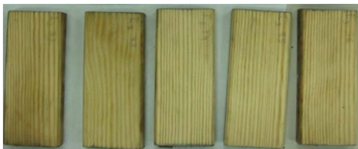
Slika 12: Pomodrele površine nestaranih vzorcev zaščitenih z IPBC in propikonazol brez veziva po izpostavitvi glivam modrivkam
