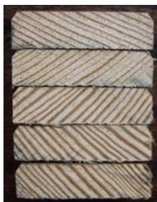
Slika 15: Obarvan presek umetno staranih vzorcev zaščitenih z IPBC in propikonazol brez veziva po izpostavitvi glivam modrivkam
