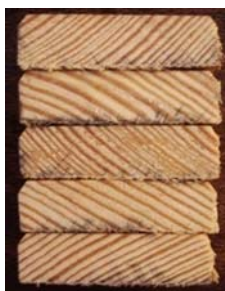
Slika 35: Obarvan presek umetno staranih vzorcev zaščitanih z razvojnim vzorcem Neocryl XK 84 po izpostavitvi glivam modrivkam
