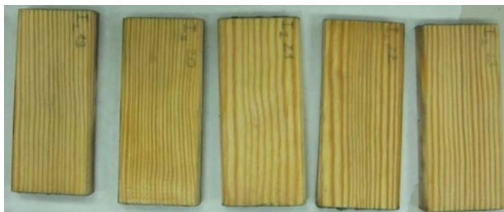
Slika 8: Nepomodrele površine nestaranih vzorcev zaščitenih z vodno impregnacijo po izpostavitvi glivam modrivkam
