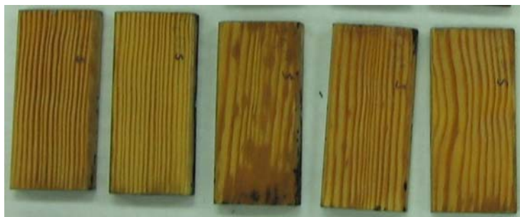
Slika 26: Minimalno oziroma nepomoderle površine umetno staranih vzorcev zaščitenih z industrijsko vodno impregnacijo po izpostavitvi glivam modrivkam
