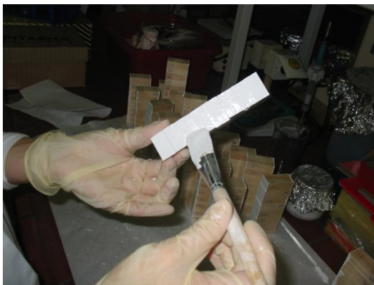
Slika 1: Premazovanje čel z epoksidnim premazom
