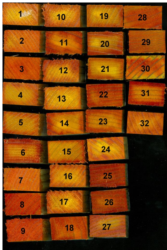
Slika 9: Prečni prerezi impregniranih vzorcev, oranžno obarvana površina predstavlja prisotnost borovih ionov
