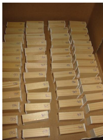
Slika 2: Označeni smrekovi vzorci dimenzij 1,5 \times 2,5 \times 5 cm
