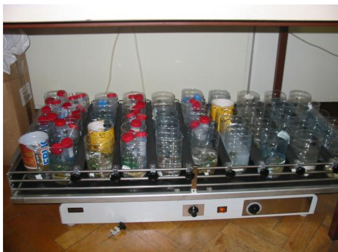
Slika 4: Čaše z impregniranimi vzorci na električnem stresalniku KAMBIČ
