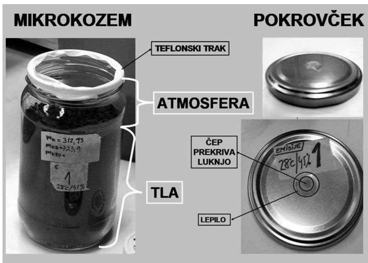
Slika 8: Priprava mikrokozma za merjenje emisij.
