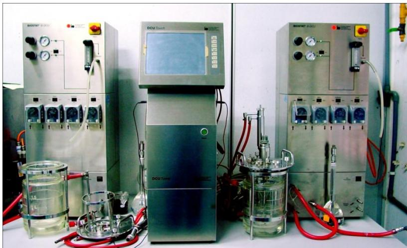
Slika 9: Laboratorijska reaktorja Biostat B-DCU (prostornina 2000 ml)
