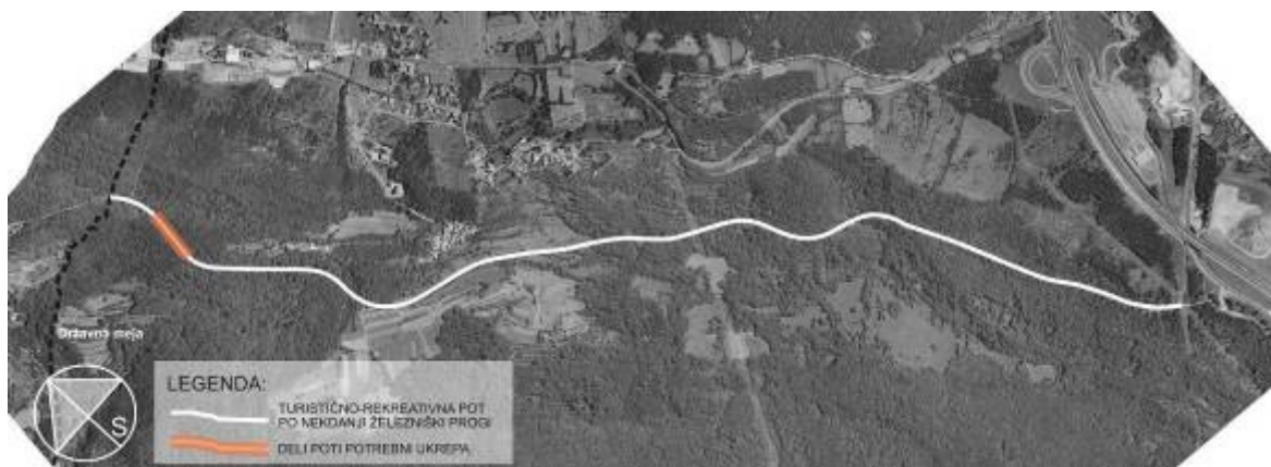
Slika 101: Prikaz dela poti, potrebnega ukrepa odstranitve kamenja s trase in utrditve brežin (kart. podl. DOF, 2006)
