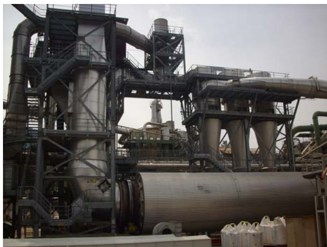
Slika 5: Rotacijski sušilnik Büttner, ki ga za sušenje uporablja tovarna ivernih plošč (TIP Otiški Vrh)
