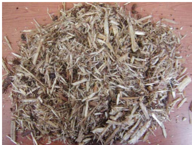
Slika 8: Iverje, dobljeno z obročastim iverilnikom
