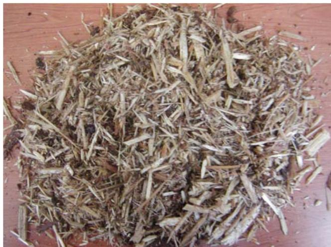
Slika 8: Iverje, dobljeno z obročastim iverilnikom
