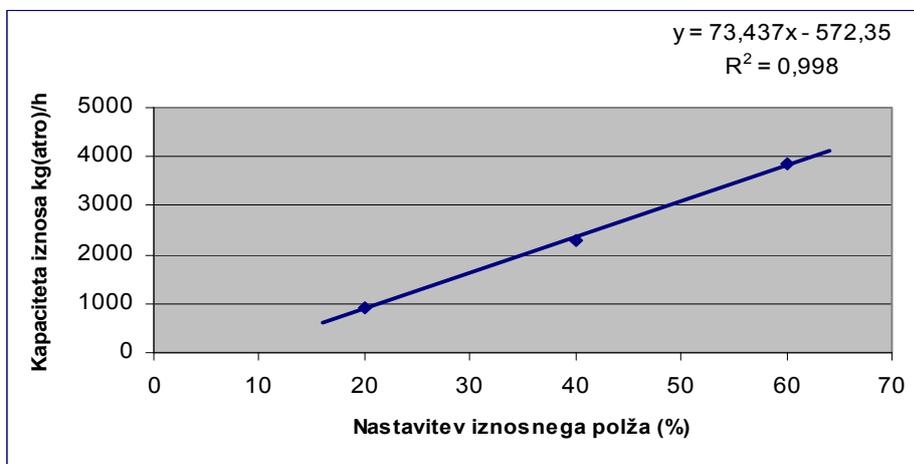
Slika 24: Odvisnost kapacitet iznosa od nastavitve polža (merilno mesto M<sub>3,2</sub>)
