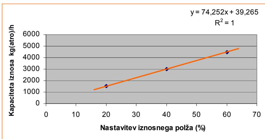
Slika 22: Odvisnost kapacitet iznosa od nastavitve polža (merilno mesto M<sub>2,2</sub>)
