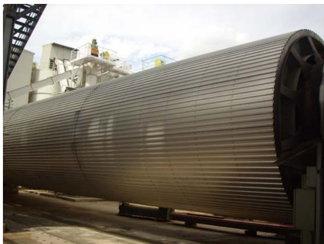
Slika 6: Sušilni valj proizvajalca Büttner
