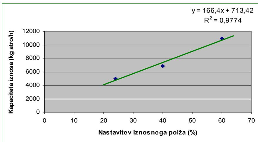
Slika 23: Odvisnost kapacitet iznosa od nastavitvev polža (merilno mesto M<sub>3,1</sub>)
