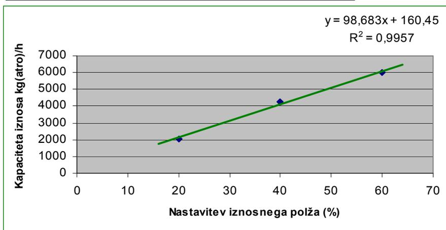
Slika 20: Odvisnost kapacitet iznosa od nastavitve polža (merilno mesto M<sub>1,2</sub>)
