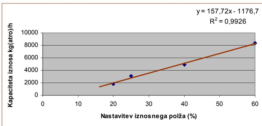
Slika 26: Odvisnost kapacitet iznosa od nastavitve polža (merilno mesto M<sub>4,2</sub>)
