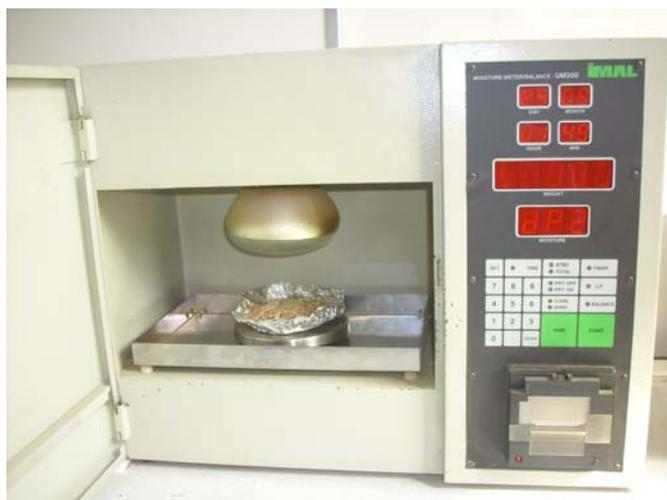
Slika 15: Laboratorijski merilnik vlažnosti
