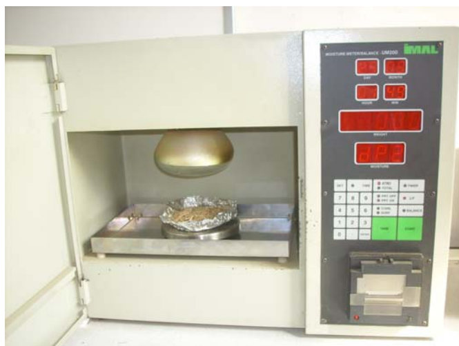
Slika 15: Laboratorijski merilnik vlažnosti
