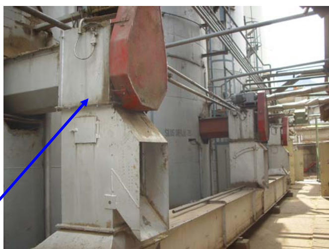
Slika 13: Merilna mesta (iznosni polži iz silosov)
