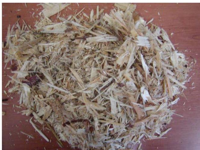
Slika 9: Iverje, dobljeno z valjčnim diskontinuiranim iverilnikom
