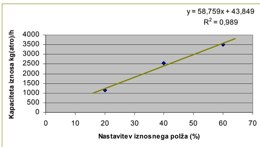
Slika 25: Odvisnost kapacitet iznosa od nastavitve polža (merilno mesto M<sub>4,1</sub>)
