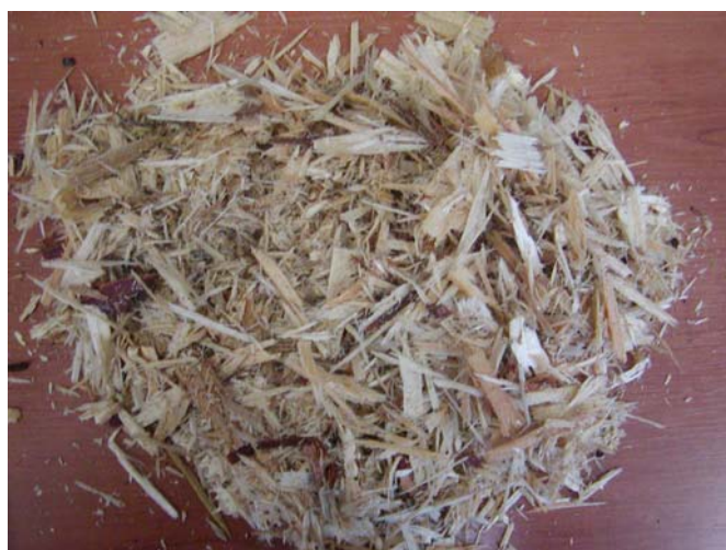
Slika 9: Iverje, dobljeno z valjčnim diskontinuiranim iverilnikom
