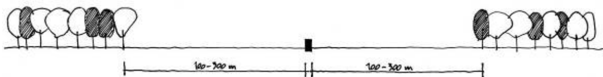
Slika 11: Prerez izsekanega gozda (brisanega prostora) ob zapornih zidovih
