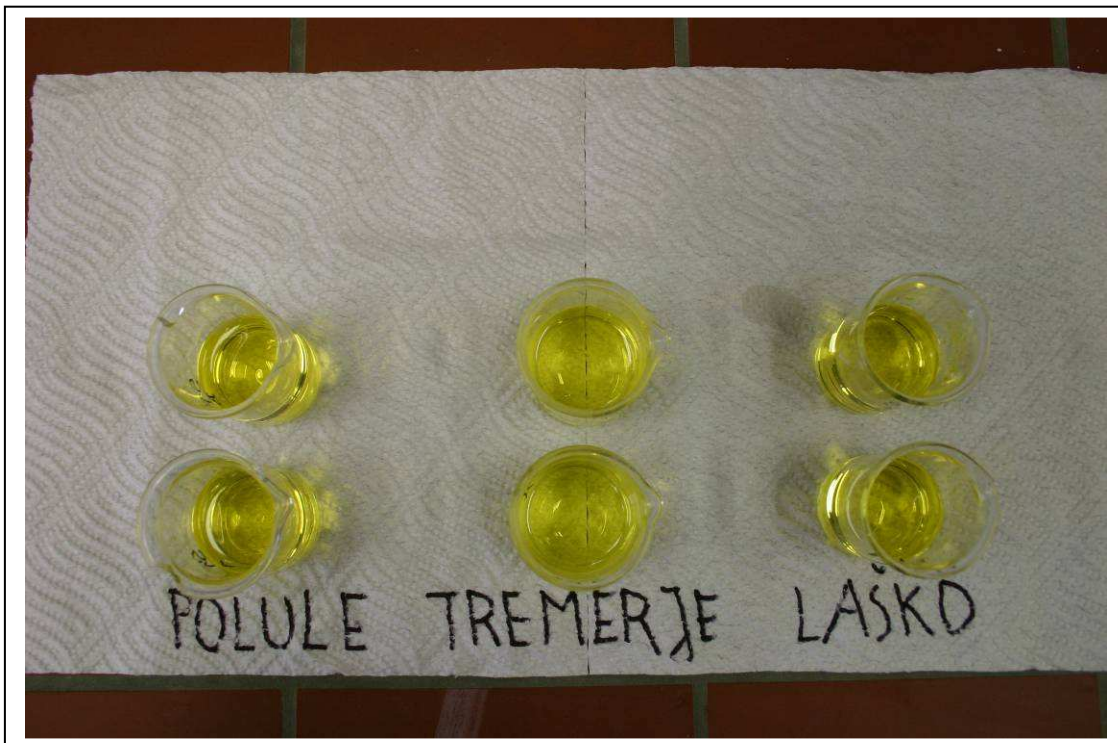
Slika 8: Po dodatku reagentov za določanje koncentracije nitratnih ionov se vzorci vode, ki vsebujejo nitrate, obarvajo rumeno
