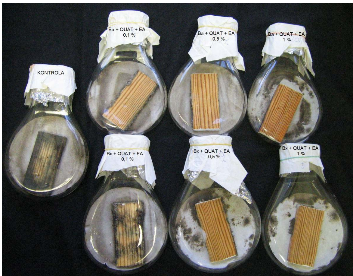
Slika 26: Izpostavitve impregniranih in neimpregniranih vzorcev delovanju gliv modrivk
