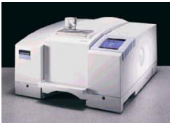
Slika 15: Perkin Elmer FT-IR Spectrum ONE
