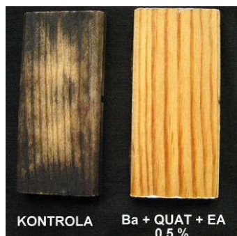
Slika 32: Primerjava pomodrelosti površine in globina obarvanja pri kontrolnih vzorcih in preizkušancih impregniranih s pripravkom Ba+QUAT+EA ( c_B = 0,5 %)
