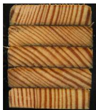
Slika 33: Primerjava pomodrelosti površine in globina obarvanja pri kontrolnih vzorcih in preizkušancih impregniranih s pripravkom Ba+QUAT+EA ( c_B = 1 \% )
