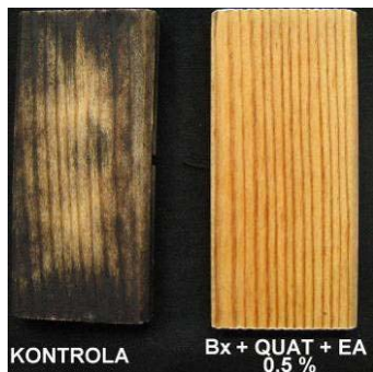
Slika 29: Primerjava pomodrelosti površine in globina obarvanja pri kontrolnih vzorcih in preizkušancih impregniranih s pripravkom Bx+QUAT+EA ( c_B = 0,5 \% )
