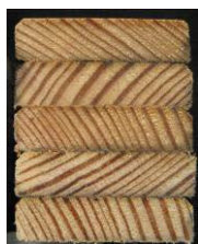
Slika 30: Primerjava pomodrelosti površine in globina obarvanja pri kontrolnih vzorcih in preizkušancih impregniranih s pripravkom Bx+QUAT+EA ( c_B = 1 \% )
