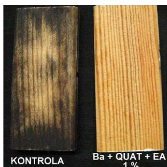
Slika 33: Primerjava pomodrelosti površine in globina obarvanja pri kontrolnih vzorcih in preizkušancih impregniranih s pripravkom Ba+QUAT+EA ( c_B = 1 \% )
