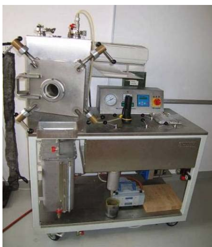
Slika 6: Vakuumsko-tlačna komora (levo) in posode z vzorci pripravljenimi za impregnacijo (desno)
