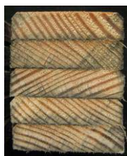
Slika 31: Primerjava pomodrelosti površine in globina obarvanja pri kontrolnih vzorcih in preizkušancih impregniranih s pripravkom Ba+QUAT+EA ( c_B = 0,1 %)
