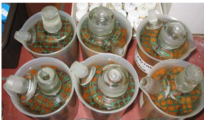
Slika 9: Postopek umetnega staranja impregniranih vzorcev (izpiranja) v skladu s standardom SIST EN 84 (1996)
