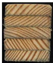
Slika 32: Primerjava pomodrelosti površine in globina obarvanja pri kontrolnih vzorcih in preizkušancih impregniranih s pripravkom Ba+QUAT+EA ( c_B = 0,5 %)
