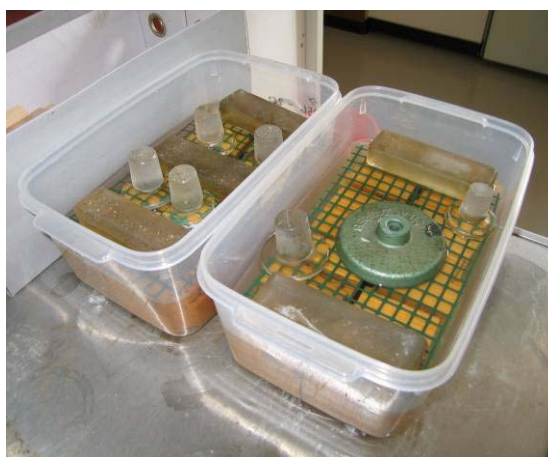
Slika 6: Vakuumsko-tlačna komora (levo) in posode z vzorci pripravljenimi za impregnacijo (desno)
