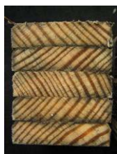
Slika 27: Izgled kontrolnih preskušancev po izpostavitvi glivam modrivkam in prikaz globine obarvanja
