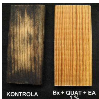
Slika 30: Primerjava pomodrelosti površine in globina obarvanja pri kontrolnih vzorcih in preizkušancih impregniranih s pripravkom Bx+QUAT+EA ( c_B = 1 \% )
