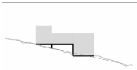
Slika št. 35: Delni vkop + stebri - različica
