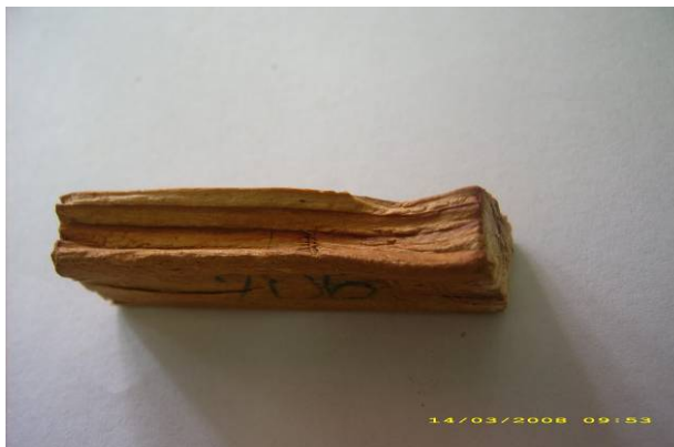
Slika 26: Smrekovi vzorci po 12 tednih izpostavitve glivam rjave trohnobe
